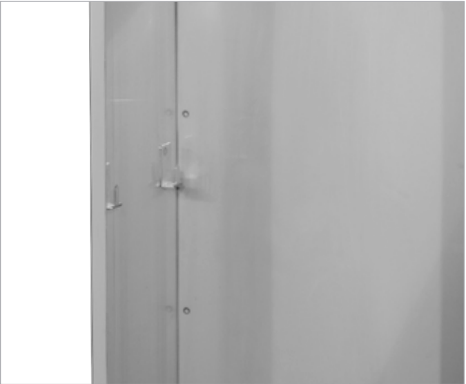
Der Abfallbeutel wird in vier Haken eingehängt.
