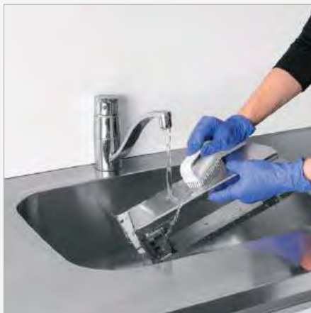
1. Das Gehäuse (inkl. Verschlussblende) unter fließend heißem Wasser mit einer geeigneten Bürste abspülen, um groben Schmutz und Ablagerungen zu entfernen. Anschließend mit einem Einmalhandtuch abtrocknen.
