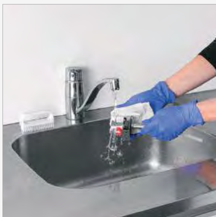
3. Nun sollte die Pumpe unter fließend heißem Wasser mit einem Einmaltuch abgespült und mehrmals von unten nach oben durchgepumpt werden, um auch die restlichen Ablagerungen im Inneren zu entfernen. Danach kann die Pumpe durch das Ablegen auf einem Papierhandtuch getrocknet werden.
