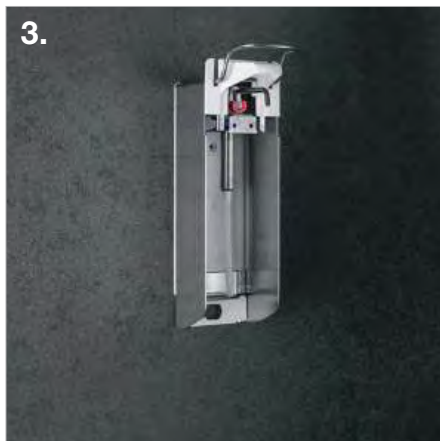
3. Entfernen Sie den Clip und schieben Sie die Kunststoffblende am Kopf des Spender nach oben, um die Pumpe entnehmen zu können.
