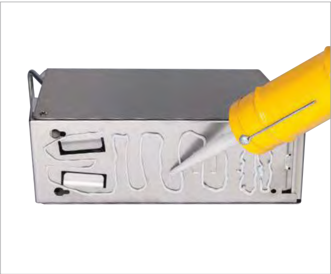
Besser: Zusätzliche Sicherung des Spenders durch Verklebung.
