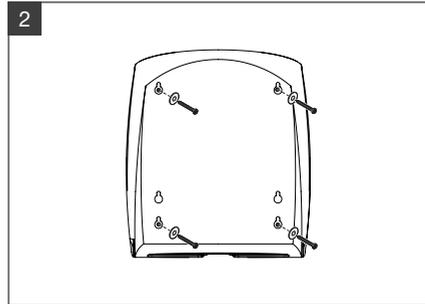
Spender mit dem Schraubensatz an der Wand befestigen.
