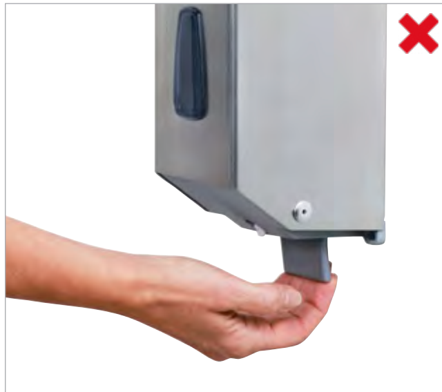
Falsch: Durch das Ziehen bei der Bedienung kann sich die Befestigung des Spenders lockern.
