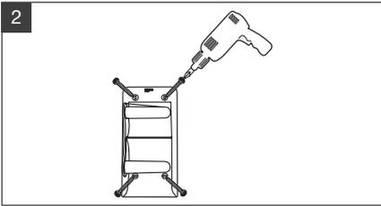
Befestigen Sie den Spender mit den Dübeln und Schrauben an der Wand.
