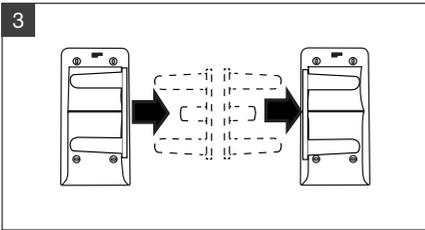
Es ist möglich, die Einführungsseite der Rollen zu wählen, indem Sie die Stützplatte herausziehen und sie anschließend auf der gegenüberliegenden Seite einsetzen.
