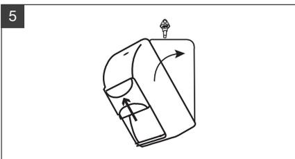
Schließen Sie den Spender mit dem Schlüssel und stellen Sie sicher, dass das Sichtfenster oben positioniert ist.
