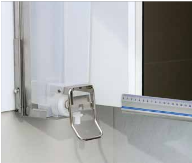
Auch bei Verwendung einer Führungsschiene sollte immer ein Abstand von mindestens 10 mm zwischen Spender und Spiegelfläche eingeplant werden.
