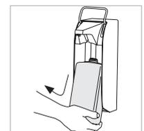
Zur Reinigung entnehmbare Innenbehälter
