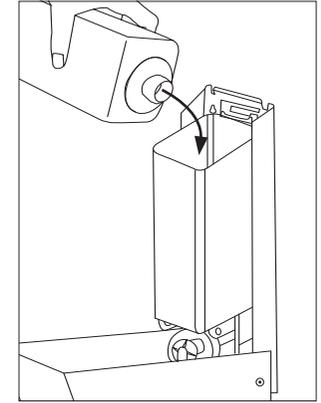
Behälter mit geeignetem Medium auffüllen und Deckel schließen.
