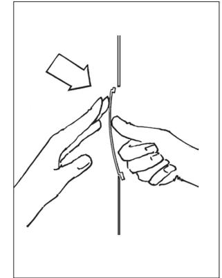
Durch Gegendruck auf der Innenseite das Fenster so weit krümmen, dass es oben eingepasst werden kann.
