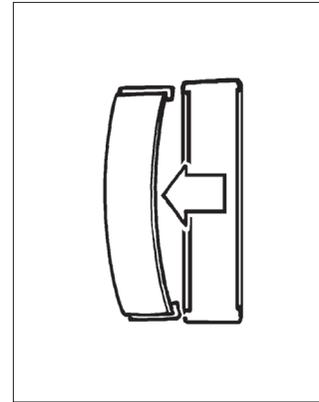
Gehäuse öffnen und das Sichtfenster von der Innenseite des Gerätes aus herausdrücken.
