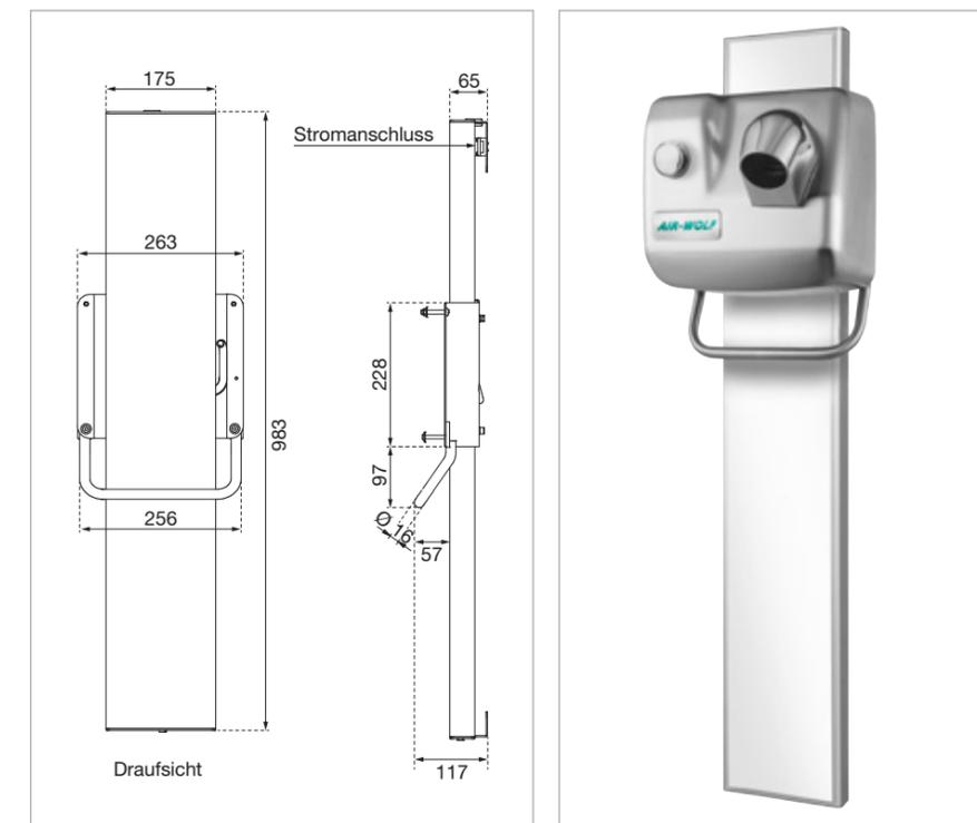
Art. 12-523: Technische Zeichnung der Höhenverstellung mit Stromanschluss.
