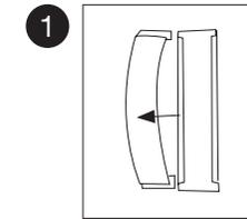
Gehäuse öffnen und das Sichtfenster von der Innenseite des Gerätes aus herausdrücken.
