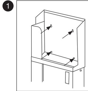
Gerät mit 4 Schrauben
