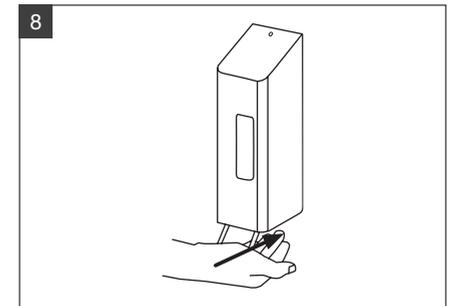
8 Hebel einige Male bedienen, bis der Spender dosiert.
