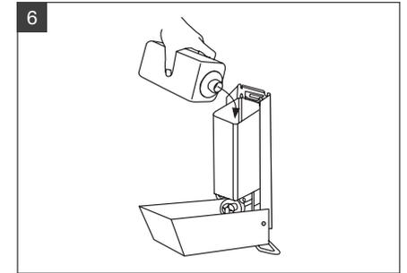
6 Behälter mit geeignetem Medium auffüllen und Deckel schließen.
