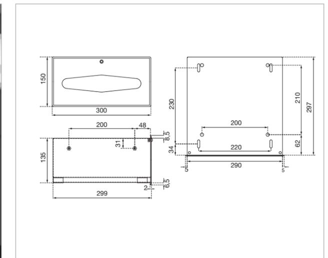
Waagerechter Einbau in der Front des Waschtisches.
