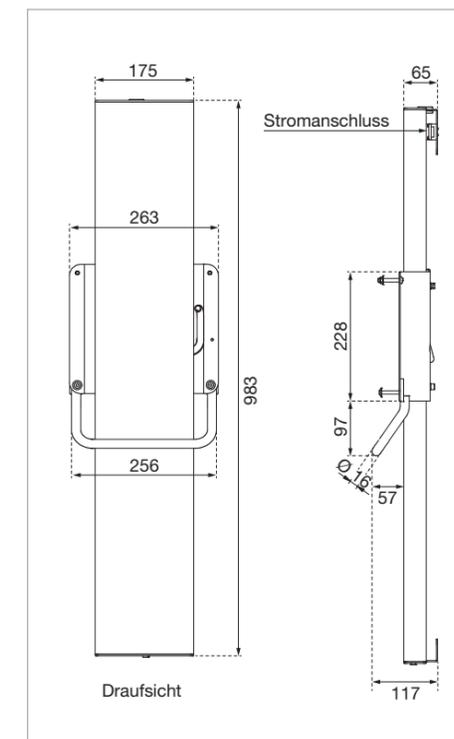
Art. 12-524: Technische Zeichnung der Höhenverstellung mit Stromanschluss.
