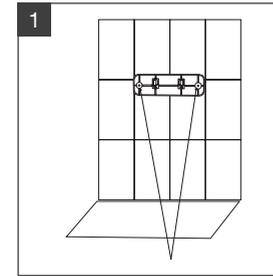
Befestigen Sie die Platte mit dem Schraubensatz an der Wand.
